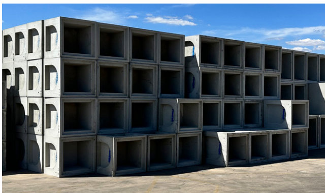
Pozos de aguas pluviales: se eliminó la malla de acero, lo que eliminó 1 día completo de trabajo de preparación en 2 días del ciclo de producción.
