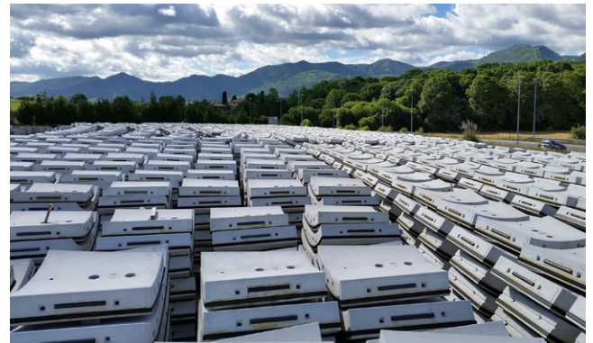
Túnel Santona Laredo: BarChip redujo la huella de carbono en un 77% respecto del diseño de acero original y los costos generales del segmento en ~40%
