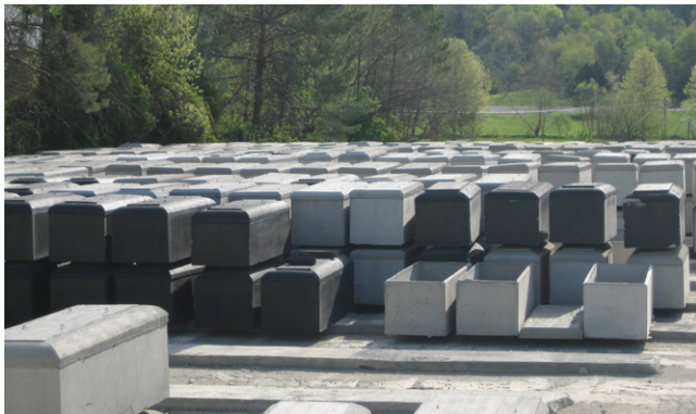
Bóvedas Funerarias: Se eliminó el refuerzo de acero de bóvedas y tapas, reduciendo costos y aumentando la velocidad de producción.
