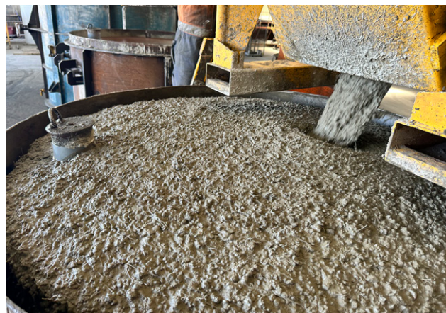
Fundición de fosas sépticas
