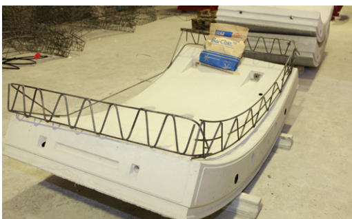
Túnel Santoña Laredo: el cambio de jaula de acero a BarChip redujo los costos totales del segmento en casi un 40%.
