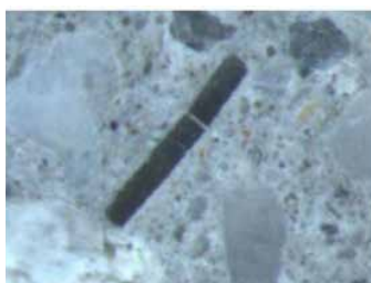
Imagen 3: Las fibras sintéticas de mala calidad pueden sufrir de fallas y daños mecánicos como fisuración (arriba) y división (al fondo) durante las operaciones de proyección de hormigón (Kaufmann 2014)
