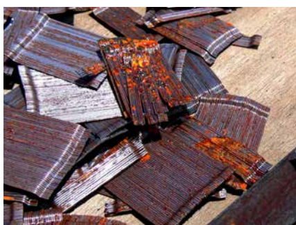
Corrosión de las fibras de Acero
