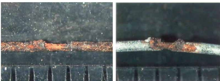
Figura 2: Pérdida de diámetro de la fibra como resultado de la corrosión en las grietas (Nordström, 2001)
